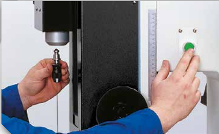
Équipement en option machines man. : système pneumatique de changement rapide des électrodes
